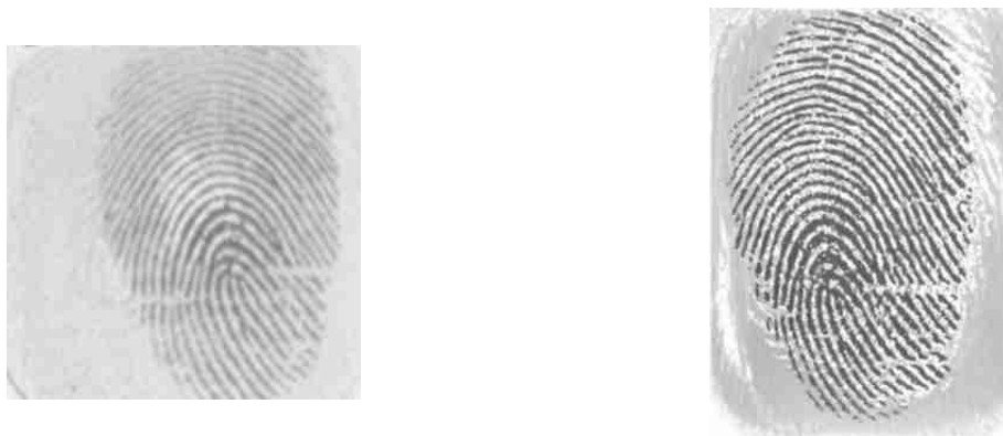
Abbildung 5. Graustufenbilder eines Fingerabdruckes. Das linke Bild wurde mit einem optischen Sensor erzeugt, das rechte mit einem kapazitiven Sensor.
